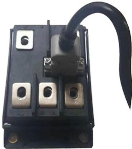
可控硅模块通常被称之为功率半导体模块。早是在1970年由西门康公司率先将模块原理引入电力电子技术领域，是采用模块封装形式，具有三个PN结的四层结构的大功率半导体器件。可控硅模块从内部封装芯片上可以分为可控模块和整流模块两大类；从具体的用途上区分，可以分为：普通晶闸管模块(MTCMTXMTKMTA)、普通整流管模块(MDC)、普通晶闸管、整流管混合模块(MFC)、快速晶闸管、整流管及混合模块(MKCMZC)、非绝缘型晶闸管、整流管及混合模块（也就是通常所说的电焊机所用模块MTGMDG）、三相整流桥输出可控硅模块(MDS)、单相（三相）整流桥模块(MDQ)、单相半控桥（三相全控桥）模块(MTS)以及肖特基模块等。可控硅模块优点编辑体积小、重量轻、结构紧凑、可靠性高、外接线简单、互换性好、便于维修和安装；结构重复性好，装置的机械设计可以简化，价格比分立器件低等诸多优点，因而在一诞生就受到了各大电力半导体厂家的热捧，并因此得到长足发展。淄博正高电气以质量求生存，以信誉求发展！宁夏三相晶闸管移相调压模块哪家好
